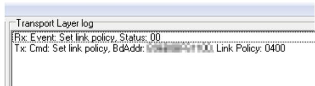
送信はTx: で、受信したデータはRx: で表示されます。なお、コマンドを解析して表示するのではなく、16進数の値をそのまま表示させたい場合には、"Transport Layer log"のウインドウ内を右クリックし、メニュー内の"Interpret Traffic"のチェックを外してください。
